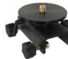
M402 klämma för tillfälliga ramar Kan fästas vid brädor på upp till 55 mm, 5/8 x 11 gänga
